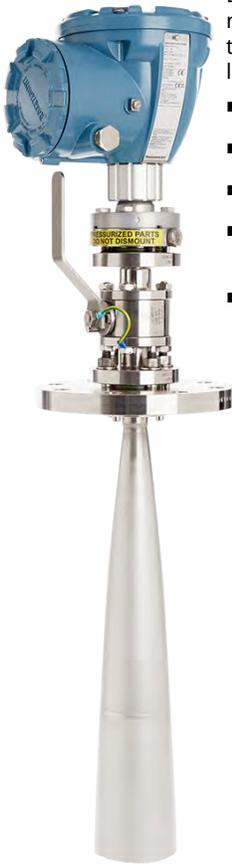
El Rosemount 5900C con antena para LPG/LNG es un indicador de nivel por radar sin contacto para realizar mediciones de gas licuado presurizado o criogénico. Las señales de radar se transmiten dentro del tubo tranquilizador para que el indicador tenga un eco lo suficientemente fuerte, incluso en condiciones turbulentas, como una superficie en ebullición.
