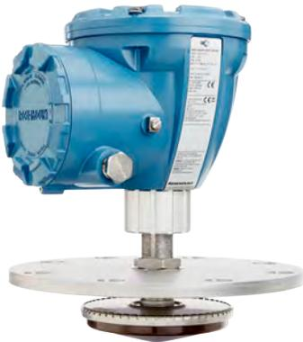
El Rosemount 5900C con matriz de antena es un medidor de nivel por radar sin contacto para medición de tubo tranquilizador. Está disponible en versiones de escotilla fija y con bisagras. Entre las aplicaciones típicas se encuentran tanques de petróleo con techos flotantes y tanques de gasolina/producto con o sin techos flotantes internos.
