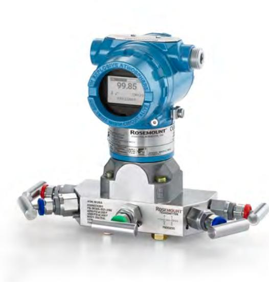
Los transmisores de presión Rosemount 3051C Coplanar son el estándar de la industria para medición de presión diferencial, manométrica y absoluta. La plataforma Coplanar permite una integración transparente con manifolds, soluciones de caudal y de nivel.
