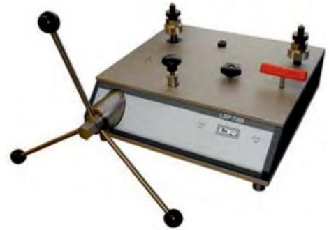
La bomba de prueba comparativa LR-Cal LSP-7000 está equipada con dos conexiones para la muestra de prueba y el instrumento de referencia que se pueden utilizar en cualquier orden. S
